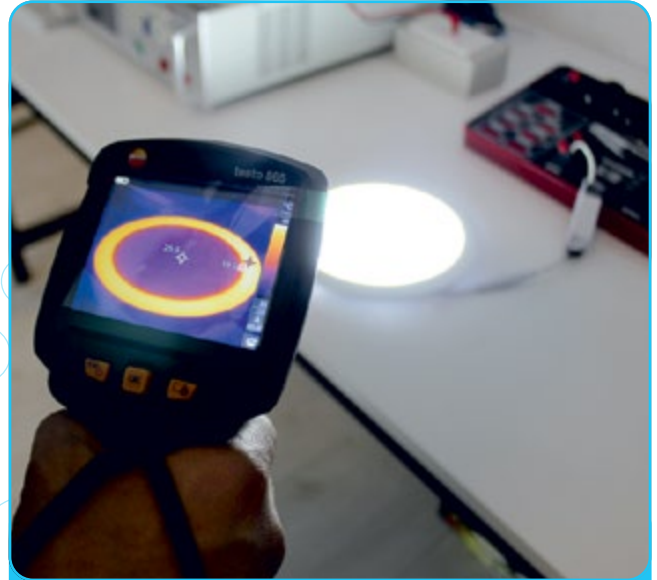
Ürünlerin çalışma sıcaklıklarının tespiti, panelin soğutma işlevi kontrolleri
