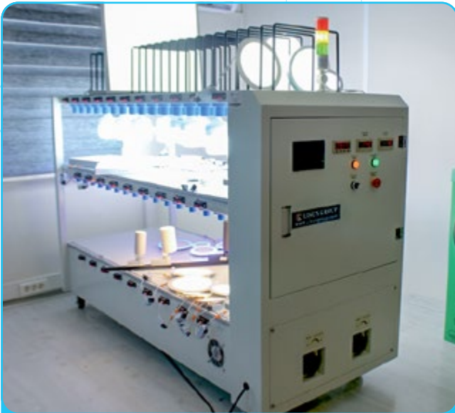
Yaşlandırma testi ile armatürlerin ömür analizi
