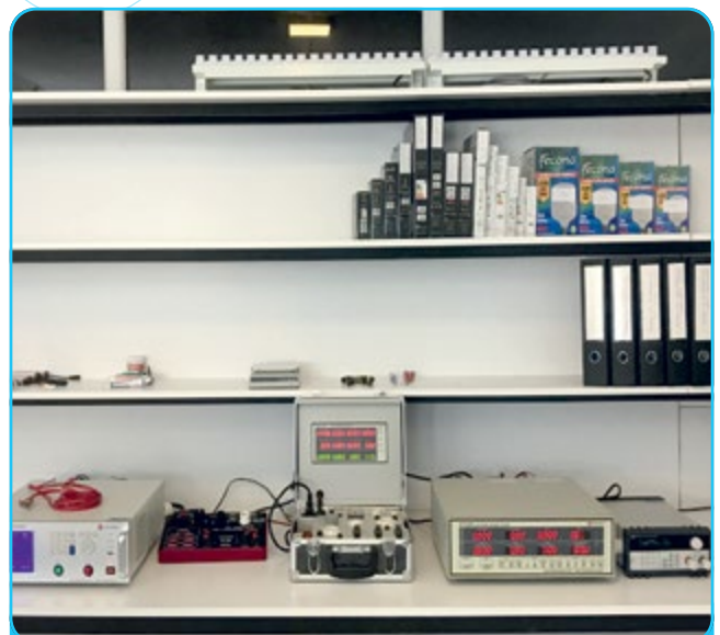
Yüksek voltaj, topraklama sürekliliği, yalıtım direnci testleri ve sürücü kartlarının (driver) elektriksel analizleri
