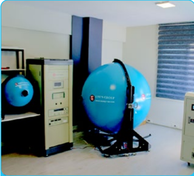
Spektrodyometre ve Entegre Küre Sistemi ile ürünlerin fotometrik analizi
